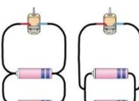
C：速くなったつなぎ方は、乾電池の+極ともう一つの乾電池の-極がつながっている。
